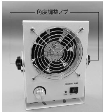
角度を固定する場合は、付属の角度固定ネジ（スプリングワッシャー・ワッシャー付）をご使用ください。角度調整ノブの下にあるネジ穴に差し込み、プラスドライバー④No.2で締め付けます。
