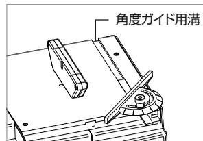
3. 角度ガイドで材料を押すようにして切断します。平行ガイドを併用すると操作性、安定性が増します。小さい材料ではぜひご使用ください。
