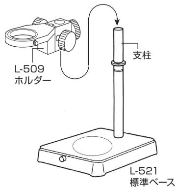
L-521の場合は支柱の標準位置マーク（溝）にL-509ホルダーの上端を合わせると、ステージにピントが合います。
