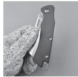
9 背面のグリップの穴に3で取り外したセンターネジを取り付け(①)、プラスドライバー④No.2で締め付けます(②)。
