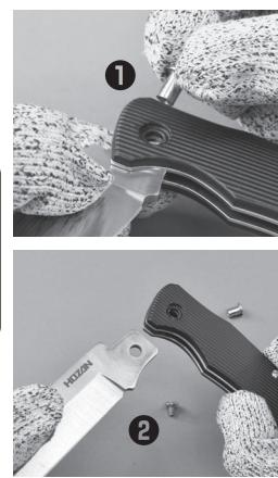
4 替刃の取付穴を保護ケースから露出させます。
