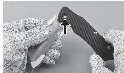
6 3で取り外したセンターナットを表面のグリップの穴から挿入します。背面のセンターネジはまだ取り付けません。
