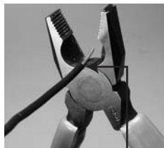
ストリップした被覆の端を引っ掛ける
