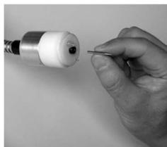
2週間に一度は電極のクリーニング、半年に一度は電極の摩耗のチェックを行ってください。電極の先端は新品時鋭利ですが、使用にともない丸くなってきます。電極周辺のクリーニングにもかかわらず除電効果が芳しくない場合は交換の必要があります。
