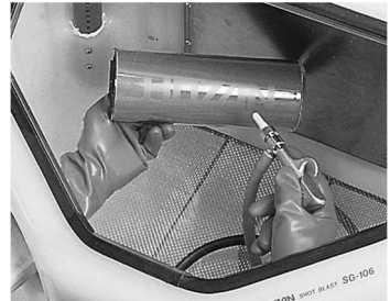
作業例(加工部分以外を透明フィルムでマスキングしています)
