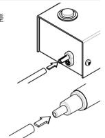
**3** プローブの先端に作業目的に適したノズルとパットを装着します。 細型ノズルはパットなしで使用します。
